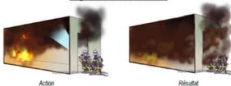
Danger de déstratification des fumées
